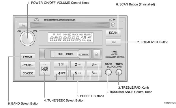
STEREO RADIO OPERATION (H280) (If installed)
